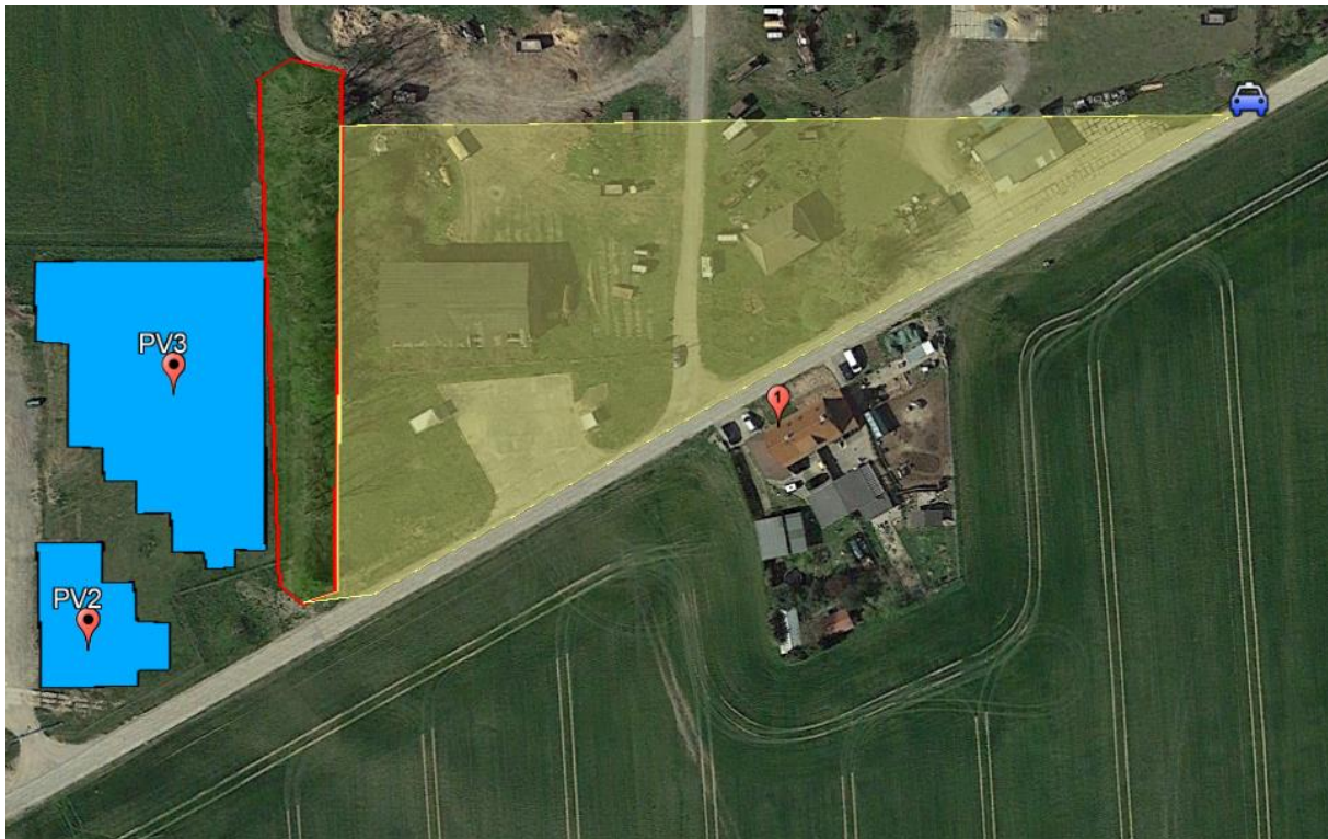
Abbildung 16: Rechtsseitiges Sichtfeld bei Fahrtrichtung Südwesten bei +30° in Fahrtrichtung (in gelb) und bestehende Sichtunterbrechungen (rot umrandet)
